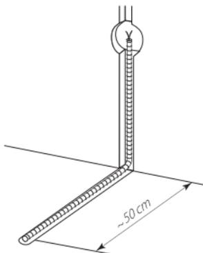
**ВАЖНО!** Открытый конец трубки с установочным проводом должен заканчиваться у терморегулятора или распаечной коробки\*, иначе заменить датчик без вскрытия пола или стены будет не возможно.
