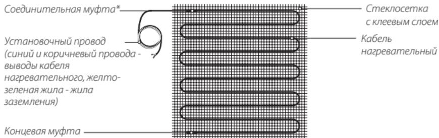
**Допускается отсутствие фиксации соединительной муфты на сетке.**
