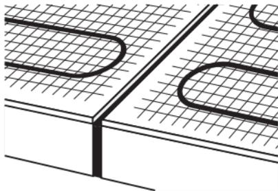
В случае, если здание имеет термокомпенсационные швы, маты должны быть расположены так, чтобы исключалась всякая возможность прохождения кабеля нагревательного мата через шов.
