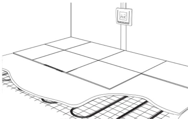
В случае использования в качестве декоративного напольного покрытия ламината, линолеума или ковролина схема укладки мата будет следующей:
